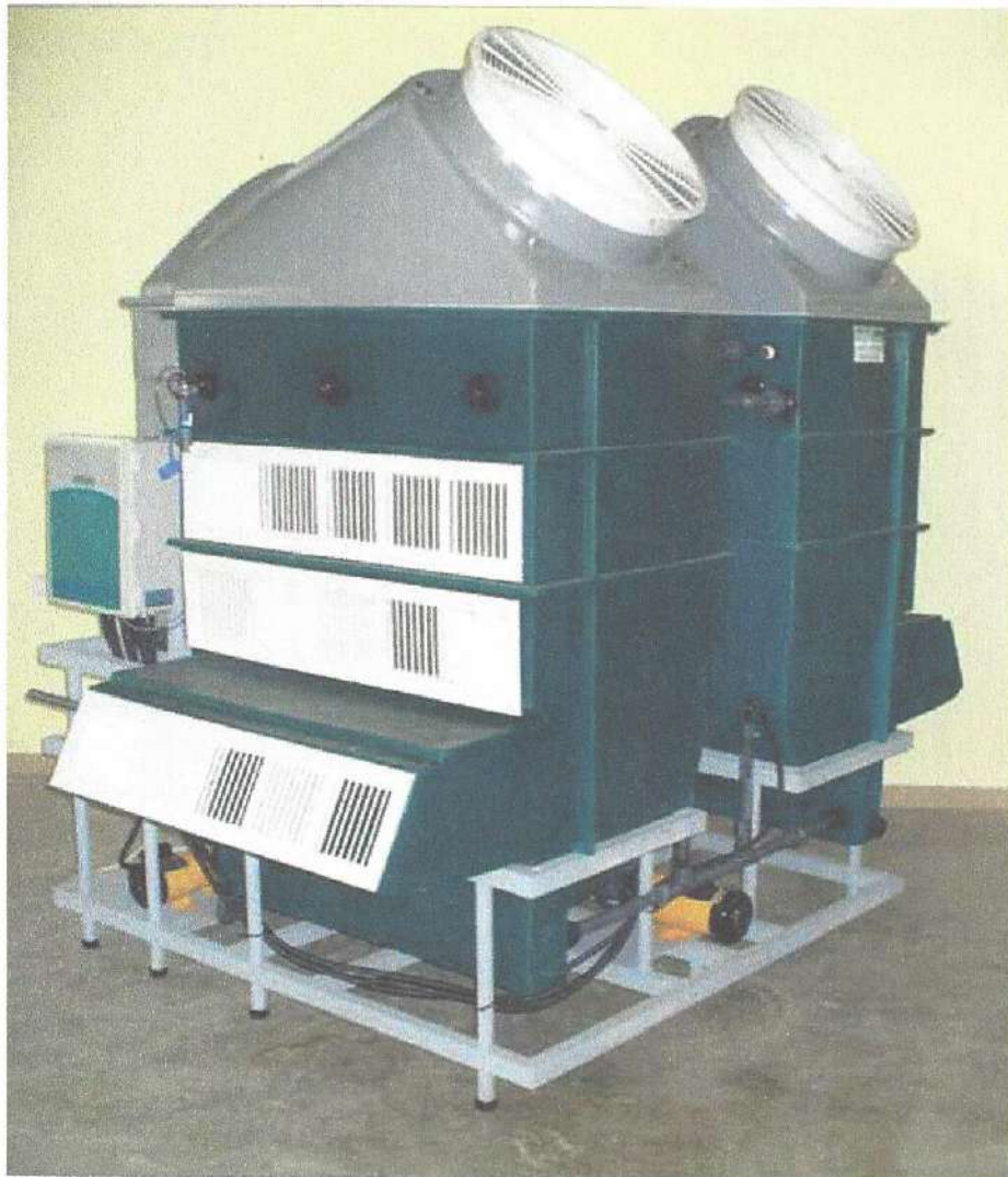
מערכת VLHC - תמיסת מלח היגרוסקופית מרוכזת סופחת רטיבות, תהליך היוצר חום המוחזר לחממה
